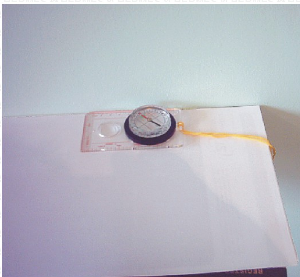
Tento obrázok nám ukazuje, ako zamerať S-J os pomocou buzoly a pevnej podložky opretej o stenu.
